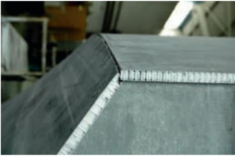
▲ Bild 2: Schiffbaulicher Plattenstoß
