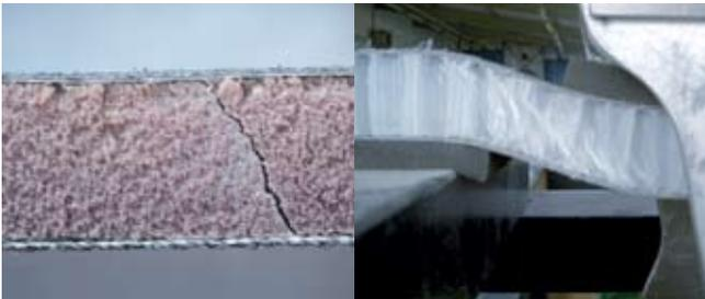
**BILD 6** Typische Versagensbilder bei Flächendruck-Beanspruchung (links: PVC-Schaumsandwich; rechts: Polypropylen-Wabenkernsandwich)
