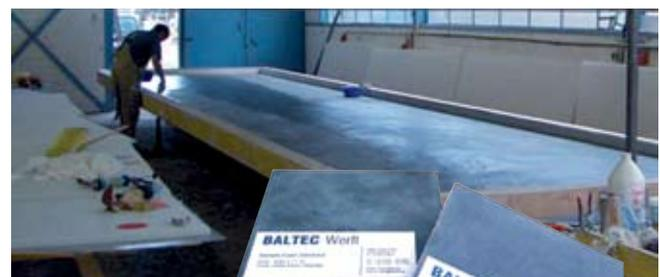
**BILD 4** Kern- und Decklagen-Materialien können entsprechend dem späteren Verwendungszweck der Platte zusammengestellt werden.
