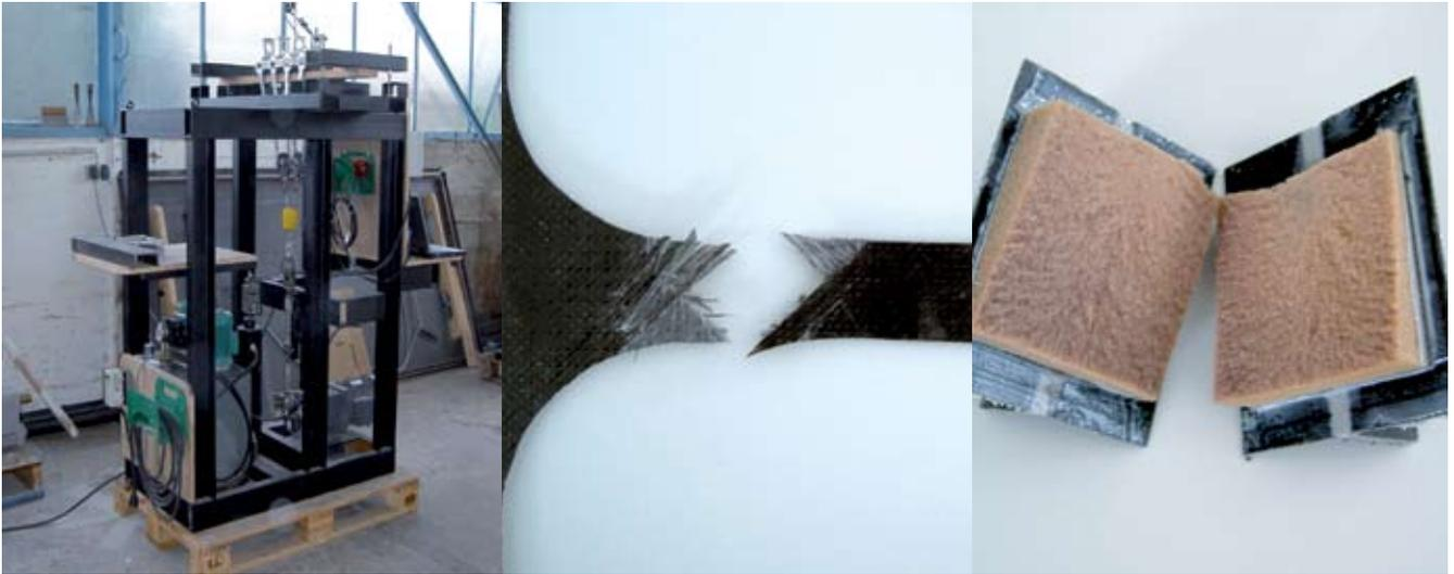
**BILD 7** Um Aussagen über die Lebensdauer der GFK-Platten bei Beanspruchung treffen zu können, wurden Sandwichstreifen Ermüdungsversuchen unterzogen und anschließend geprüft (links: Universalprüfmaschine; rechts: Ergebnis eines Zugversuchs zur Laminatfestigkeit; Mitte: Ergebnis eines Zugversuchs senkrecht zur Deckebene).
